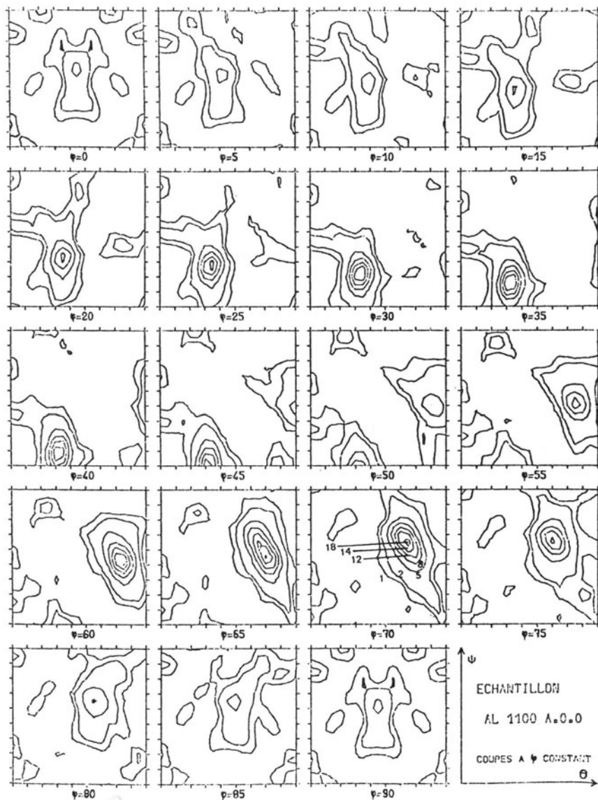
Figure 1. – Courbes de niveaux représentant les variations de la FDOC dans l'espace d'Euler pour le matériau avant déformation.
